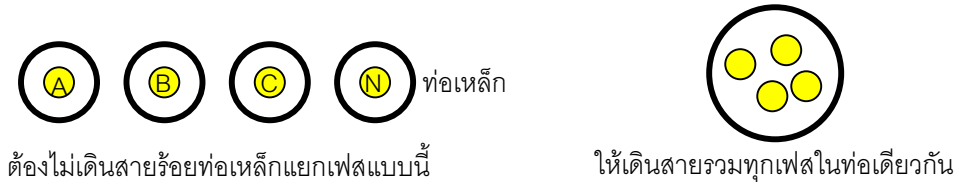
รูปที่ 7-1 แสดงการเดินสายร้อยในท่อเหล็กแบบแยกเฟส และ แบบรวมเฟส
